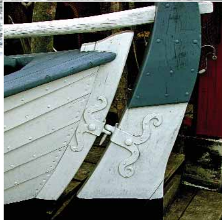
Een van de gerestaureerde scheepjes in het openluchtmuseum heeft een bijzonder fraai roerbeslag.
